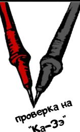
ВСЕ ИЗМЕРЕНИЯ ПРОИЗВОДЯТСЯ С ПОМОЩЬЮ ЩУПОВ, КОТОРЫЕ ПОДКЛЮЧАЮТСЯ К МУЛЬТИМЕТРУ ЧЕРЕЗ СПЕЦИАЛЬНЫЕ РАЗЪЁМЫ НА КОРПУСЕ.
