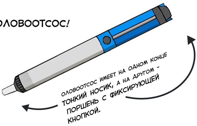
ВНУТРИ РАСПОЛОЖЕНА ПРУЖИНА, КОТОРАЯ ПРИ НАЖАТИИ НА ПОРШЕНЬ РАСТЯГИВАЕТСЯ, Но БЛАГОДАРЯ КНОПКЕ-ФИКСАТОРУ НЕ ВОЗВРАЩАЕТСЯ В ИСХОДНОЕ ПОЛОЖЕНИЕ.
