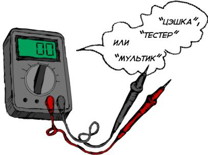
НАПРЯЖЕНИЕ И ТОК бывают ПЕРЕМЕННЫМИ (КАК В ЭЛЕКТРИЧЕСКОЙ РОЗЕТКЕ) И ПОСТОЯННЫМИ (КАК В АККУМУЛЯТОРЕ СМАРТФОНА). В СВЯЗИ С ТЕМ, ЧТО ОНИ РАЗНЫЕ, ТО И ИЗМЕРЯЮТ ИХ ПО-РАЗНОМУ.
