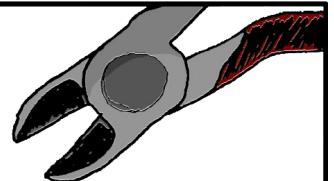
Держа заточенной стороной вниз, поднесите кусачки к выводу, прицелившись чуть выше бугорка припоя. Сожмите ручки, и режущие кромки с щелчком перережут ножку...
