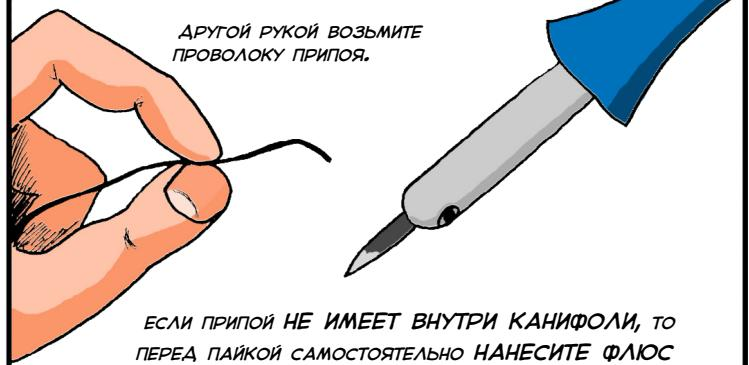
ЕСЛИ ПРИПОЙ НЕ ИМЕЕТ ВНУТРИ КАНИФОЛИ, то перед пайкой самостоятельно НАНЕСИТЕ ФЛЮС на контактные площадки и выводы для их очистки.
